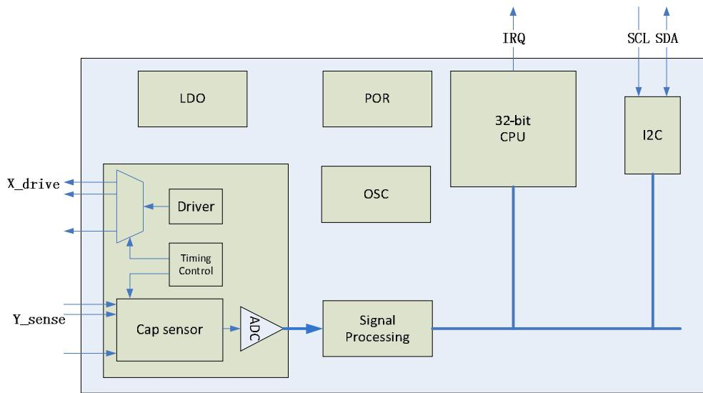
GSL3676 采用了独特的互电容感应技术。它可以在 1ms 内测量多达 192 个节点。
